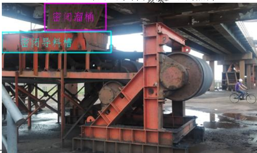
图 6.2-3 封闭式结构转运站示例照片
